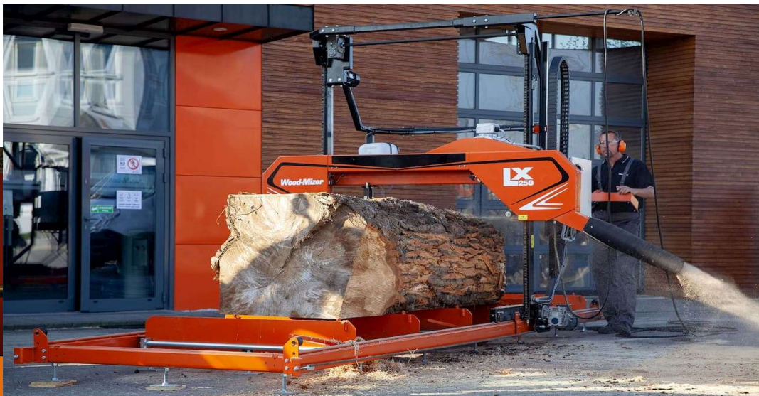
STANDARD UTRUSTAD MED HYDRAULISK BANDSPÄNNING!
