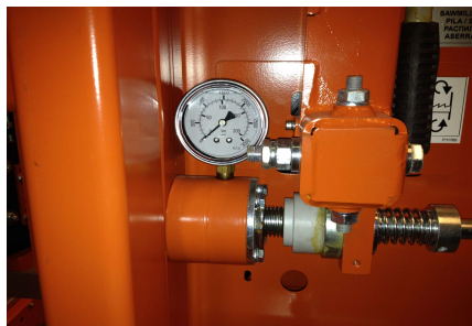
STANDARD UTRUSTAD MED HYDRAULISK BANDSPÄNNING!
