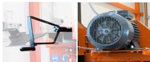
Vev till höjdinställning, 5,5kW el-motor
